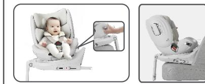
拉动座椅旋转开关，调节儿童安全座椅方向。9kg以内只能后向，9-18kg可以正前方或者正后方。
