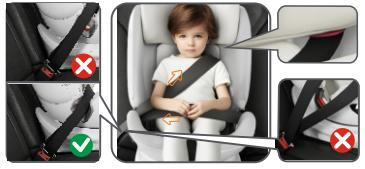
调整头靠至合适高度，将汽车三点式安全带从儿童身上穿过，保持安全带下半部分经过儿童安全座椅的腰部导向钩位置，安全带上半部分下端经过儿童安全座椅的腰部导向钩，上端经过头靠导向钩从腰部安全带开始，至安全带上端固定点位置，依次收紧安全带，并确保安全带平顺没有过度扭曲。
