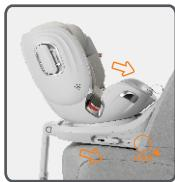
将ISOFIX接口推入汽车上的ISOFIX固定点，将安全座椅和汽车座椅推紧，直到你听到两声“咔”声。
