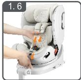
按压调节器，按图示方向将安全带调至最大。
