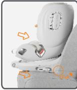
将FIT接口推入汽车上的FIT固定点，将安全座椅和汽车座椅推紧，直到你听到两声“咔”声。
