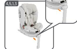
首先，从座椅底部拆出支撑腿。当支撑腿向外旋转时，支撑腿组件可向外拉出。
